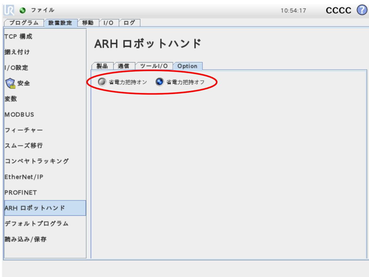
省電力把持とは、ハンドがワークを掴んでいる状態において、ハンドに供給する電流を低下させて消費電力を抑える機能です。発熱も抑制できるため過熱防止の効果もあります。
