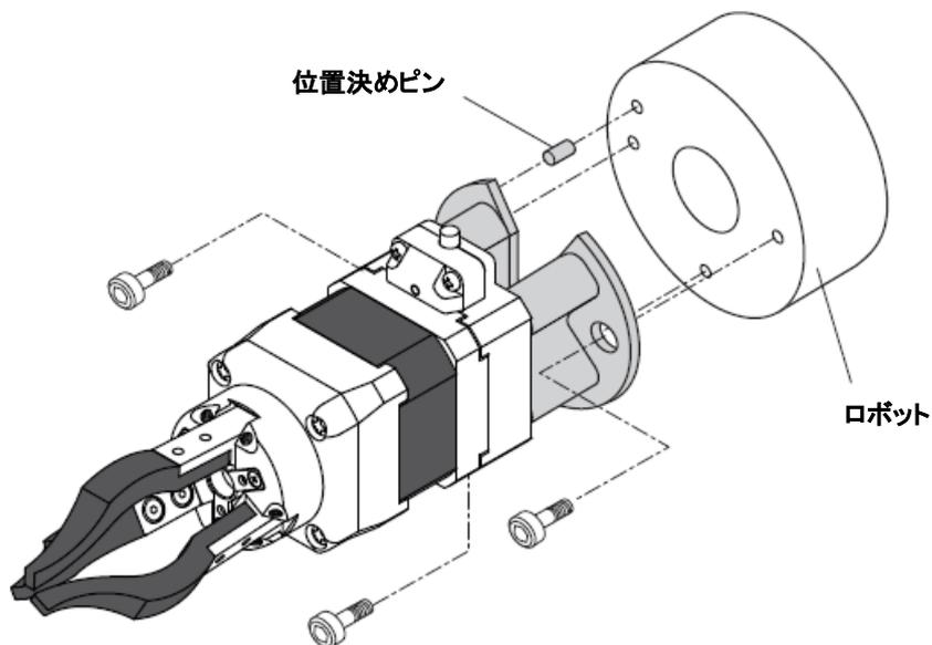
2. アタッチメントをロボットに取り付けます。
