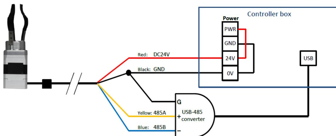
1. 通信用延長ケーブルと、USB-RS485 コンバータを用意します。
