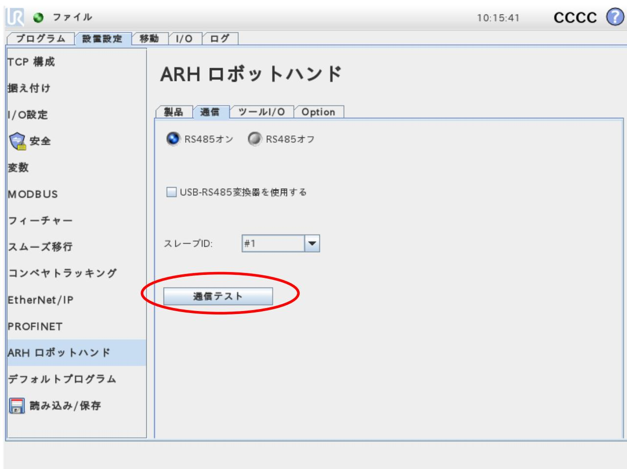
“通信テスト”をタップすると、ハンドに状態照会の通信コマンドを送信して結果を表示します。
