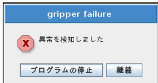
アラームを検知したら速やかにプログラムを停止させ、アラームの要因を取り除いてください。また、ハンドへの電源供給がされていない場合はハンドの ALARM 信号出力がオフ固定となるため、ロボットがアラームを検知します。ハンドに電源が供給されているか御確認ください。
