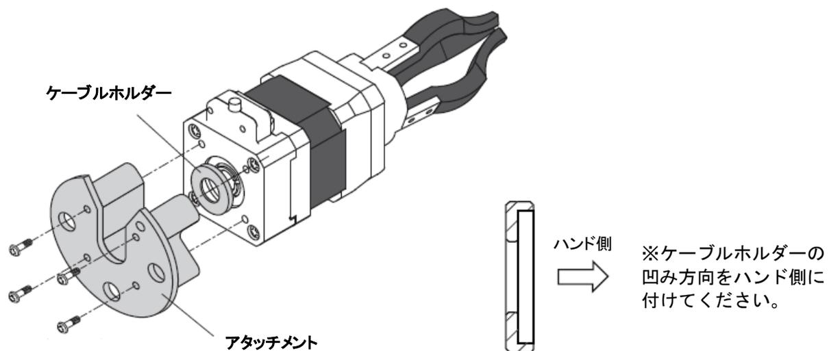
1. ロボットハンド本体に専用アタッチメントを取り付けます(専用アタッチメントにネジは同梱します)。
