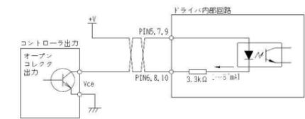
※ドライバ内部回路内のフォトカプラ電流は1 ~ 8[mA] です。
