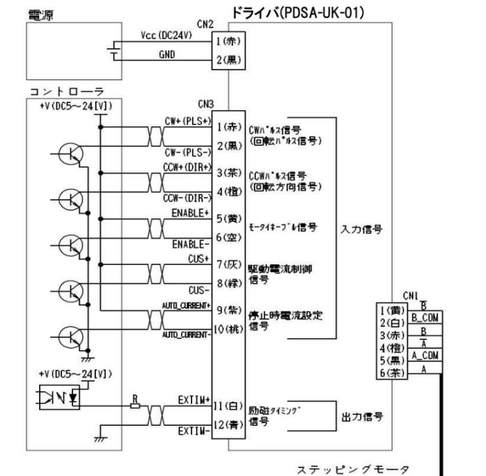
※CW(PLS)/CCW(DIR)は入力電圧に合わせてパルス信号電圧設定(SW3, 4)を設定してください。
