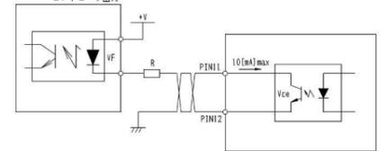
※接続先の仕様を確認し、10[mA]を超える電流をフォトカプラに流さないように必ず外部に抵抗Rを使用してください。外付け抵抗の計算式を以下に示します。
