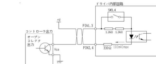
※+VにDC+5[V]を使用する場合はSW3,4の設定をONにし、DC+24[V]を使用する場合は、SW3,4の設定をOFFに設定してください。
