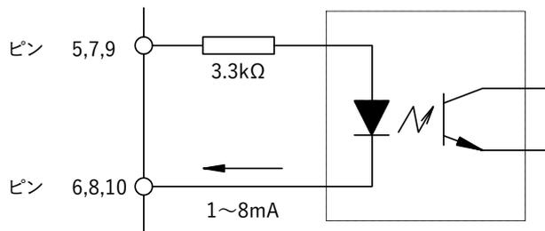
※ ドライバ内部回路内のフォトカプラ電流は 1 ~ 8[mA] です。
