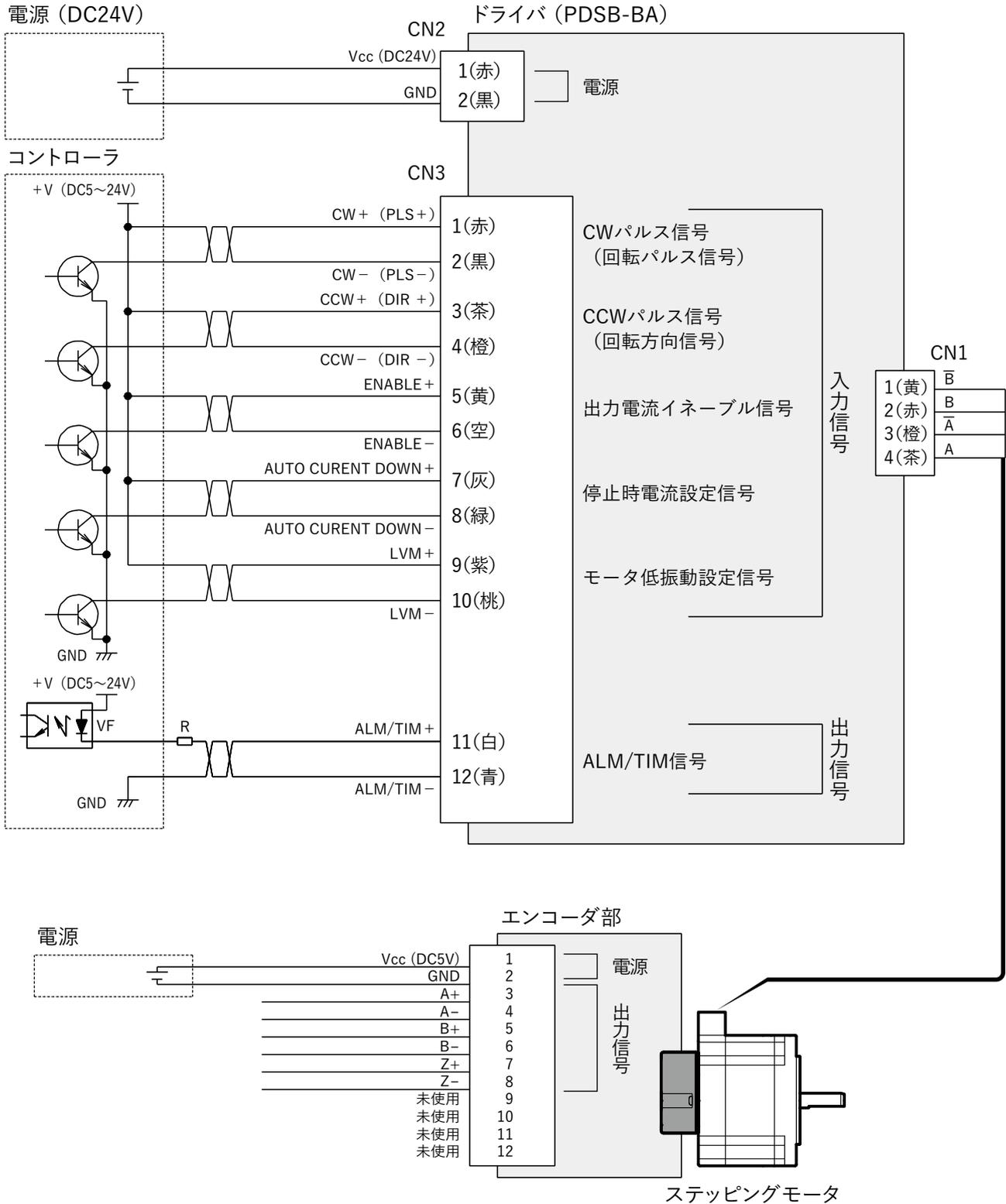
※ CW(PLS)/CCW(DIR) は入力電圧に合わせてパルス信号電圧設定 (SW3, 4) を設定してください。異なる設定で使われた場合、動作不安定やドライバ破損となります。
