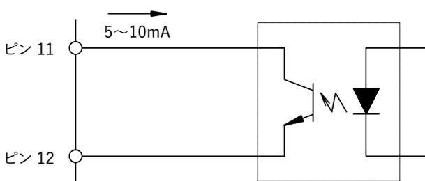
※ 接続先の仕様を確認し、10[mA] を超える電流をフォトカプラに流さないように必ず**外部に抵抗 R** を使用してください。外部抵抗 R の計算式を以下に示します。
