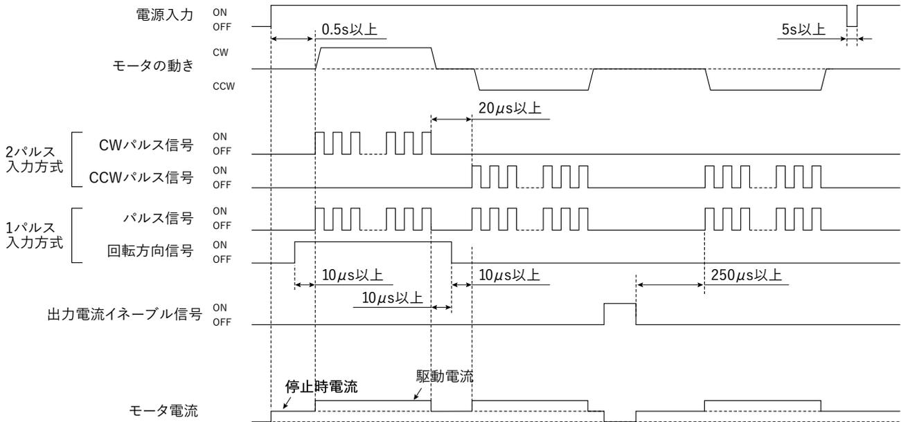
※ 2パルス入力方式時の CWパルス信号・CCWパルス信号の切り替え時間 (20 μs 以上)、1パルス入力方式時の回転方向信号の切り替え時間 (10 μs + 10 μs 以上) は、回路の応答時間を示しています。ご使用の際はモータが応答可能な時間に設定してください。
