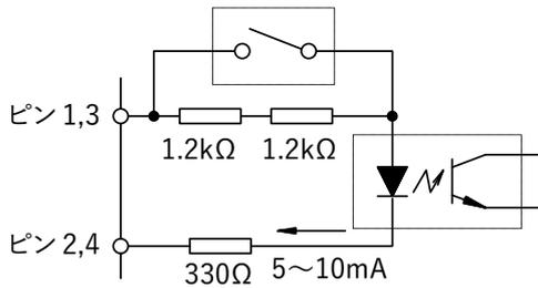
※ +V に DC+5[V] を使用する場合は、SW3,4 の設定をON。+V に DC+24[V] を使用する場合は、SW3,4 の設定をOFFに設定してください。
