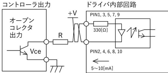
※ +V に DC+5[V] を使用する場合は、直接コントローラと接続できます（抵抗 R 不要）。
